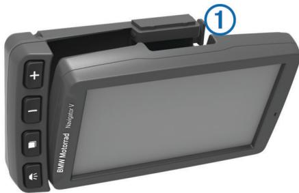
**2** Наклоните устройство назад до щелчка; защелка должна быть ровень с поверхностью.
