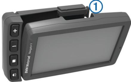
2 Inclinez l'appareil vers l'arrière jusqu'à ce qu'il soit en place et que le haut du clip de verrouillage soit à plat.
