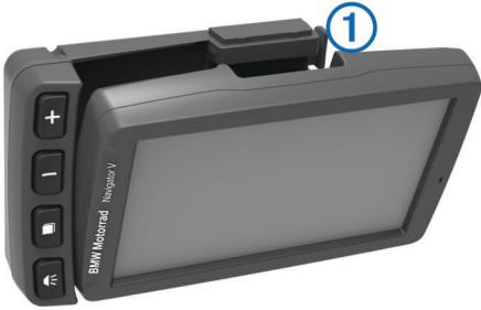
**2** Napravo nagnite nazaj, dokler se ne zaskoči na pravo mesto in vrh zapaha ni raven.
