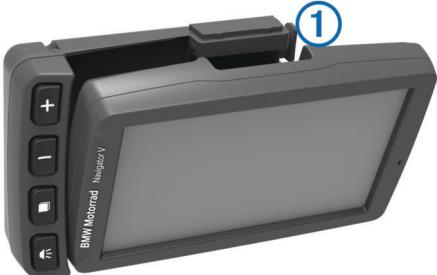
2 Przechyl urządzenie do tyłu, tak aby zatrzasnęło się na swoim miejscu, a górna część zatrzasku leżała całkowicie na płasko.
