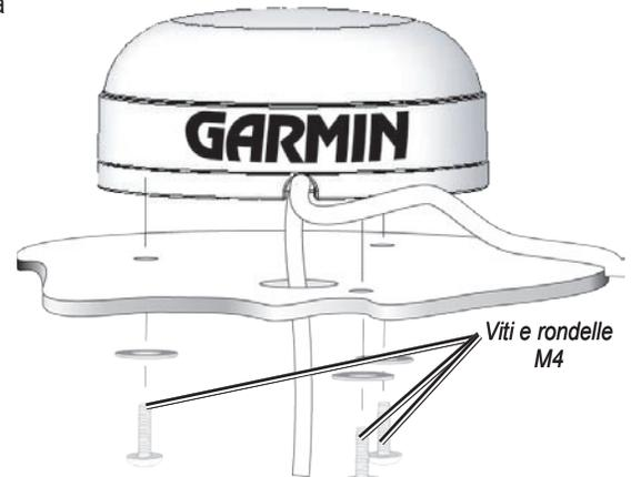
Quando viene installata l'antenna GPS 17, è possibile far passare il cavo dati di alimentazione attraverso la superficie di montaggio o all'esterno dell'unità. Se il cavo dati di alimentazione viene fatto passare attraverso la superficie di montaggio, sigillare l'area intorno all'uscita esterna con del sigillante marino.
