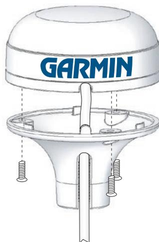
Collegamento dell'adattatore per montaggio su asta all'antenna GPS 17
