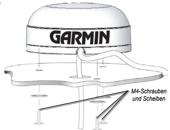
Bei der Installation der Antenne GPS 17 können Sie das Netz-/Daten-Kabel durch die Montagefläche führen oder außen am Gerät verlegen. Wenn das Netz-/Daten-Kabel durch die Montagefläche geführt wird, müssen Sie den Austrittsbereich mit seetauglichem Dichtmittel abdichten.
