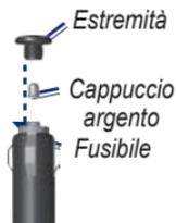
2. Rimuovere il fusibile (cilindro di vetro color argento) e sostituirlo con il tipo adatto di fusibile a lato dell'adattatore.
