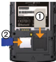
2. Inserta la tarjeta microSD ② en la ranura microSD con los contactos dorados hacia abajo.
