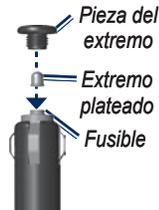
2. Retira el fusible (cilindro de color plateado y de cristal) y sustitúyelo por un fusible rápido de 3 A.
