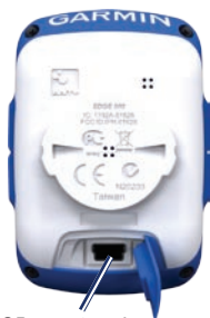
Mini-USB-poort onder het beschermkapje
