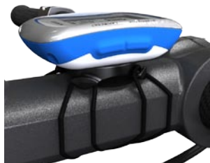
Edge-enheten monterad på styrstammen
