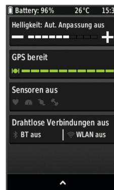
Die Statusseite der Sensoren und Verbindungen wird angezeigt. Wenn ein Symbol blinkt, führt das Gerät eine Suche durch. Du kannst ein beliebiges Symbol auswählen, um die Einstellungen zu ändern.
