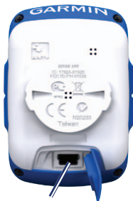
Port mini-USB sous le cache étanche
