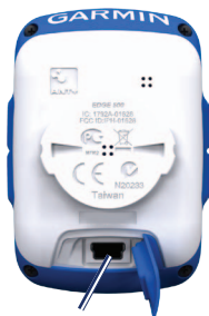
Mini-USB-poort onder het beschermkapje
