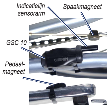
GSC 10 en magnetenuitlijning
