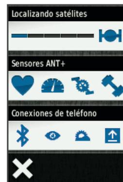
A continuación, aparecerá la página con las conexiones. Si el icono parpadea, significa que el dispositivo está buscando. Puedes seleccionar cualquier icono para cambiar la configuración.
