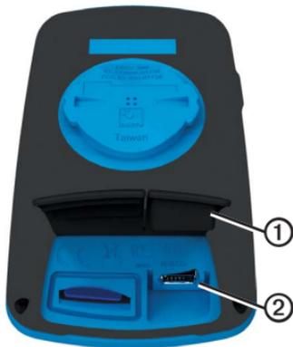
3. Schließen Sie das kleine Ende des Netzteilkabels an den Mini-USB-Anschluss an.
