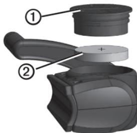
2. Drehen Sie die Abdeckung mit einer Münze gegen den Uhrzeigersinn, bis Sie sie abnehmen können. (Der Pfeil muss auf UNLOCKED zeigen.)
