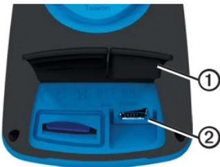
3. Stecken Sie den kleinen USB-Stecker des USB-Kabels in den Mini-USB-Anschluss.
