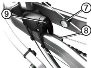
5. Coloca el radio en la ranura de la pieza de plástico y apriétalo ligeramente.
