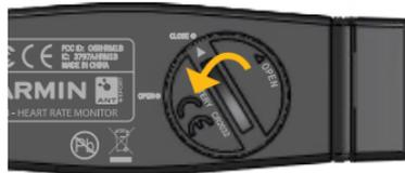
3. Entfernen Sie die Abdeckung und den Akku. Warten Sie 30 Sekunden. Setzen Sie den neuen Akku ein, wobei die Seite mit dem Plus nach oben zeigen sollte.
