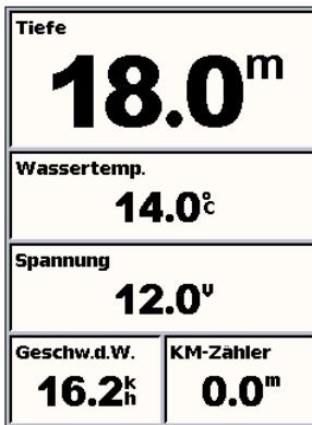
Alle Schwinger mit Echolot zeigen die Tiefe an. Schwinger mit Temperaturmessung zeigen die Wassertemperatur an. Schwinger mit Geschwindigkeitsmessung oder separate Geschwindigkeitsmessräder zeigen die Geschwindigkeit des Wassers und einen Kilometerzähler an.
