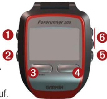
**Anmerkung:** Wenn das Gerät einfriert (nicht mehr auf Tasten reagiert), drücken Sie die Tasten **Modus** und **Runde/Reset** gleichzeitig. Das Gerät wird zurückgesetzt.
