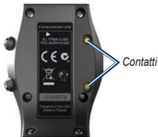
4. Fissare saldamente il caricabatterie sul quadrante dell'unità.
