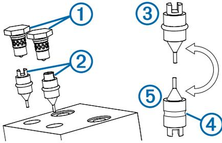
2 Trekk stemplene ② ut av pumpens manifold.
