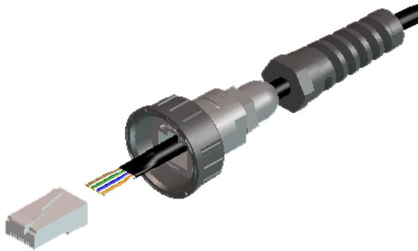
2. Crimpen Sie den Stecker mit einer AMP-Crimpzange und den entsprechenden Matrizen (bzw. mit einem gleichwertigen Werkzeug) auf die Adern. Folgen Sie hierbei den Anwendungshinweisen des jeweiligen Crimpzangenherstellers.
