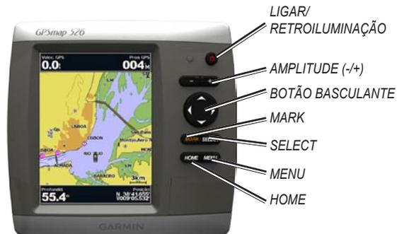
**LIGAR/RETROILUMINAÇÃO**—prima e mantenha premido para ligar ou desligar a unidade. Prima e liberte para ajustar a retroiluminação e os modos Dia e Noite.
