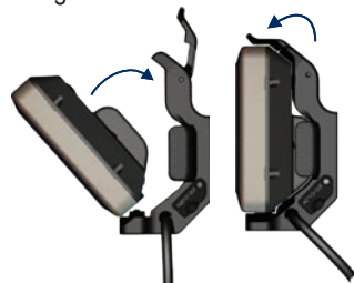
Installation du GPSMAP 620/640 sur le support de montage
