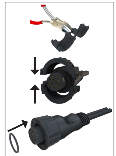
Instalación del anillo de fijación
