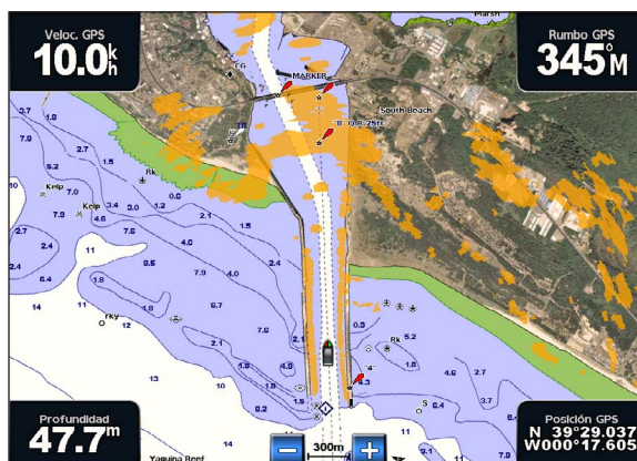
Radar Superpuesto en la carta de navegación
