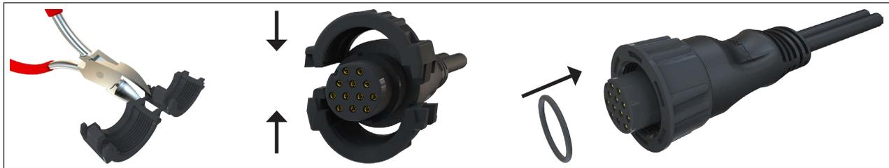
Installieren eines Sicherungsringes
