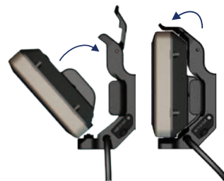
Slik setter du GPSMAP 620- eller GPSMAP 640-enheten i braketten
