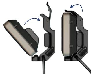
**Colocar o GPSMAP 620 ou GPSMAP 640 no suporte de montagem**
