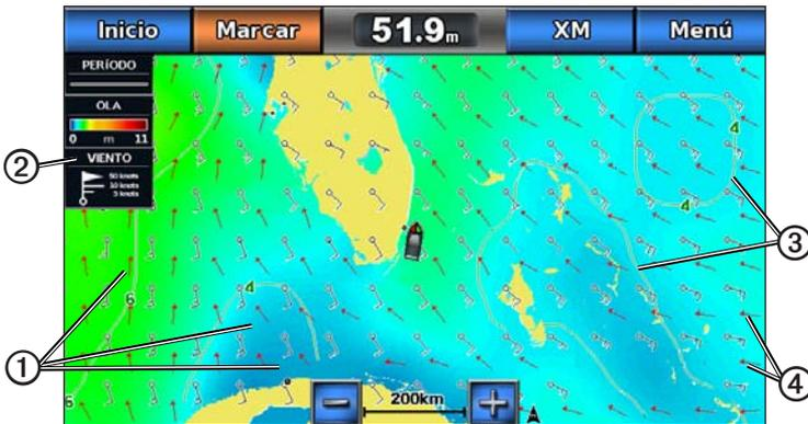
El período de oleaje indica el tiempo (en segundos) transcurrido entre una ola y la siguiente. Las líneas de período de oleaje ③ indican las áreas que tienen el mismo período de oleaje.
