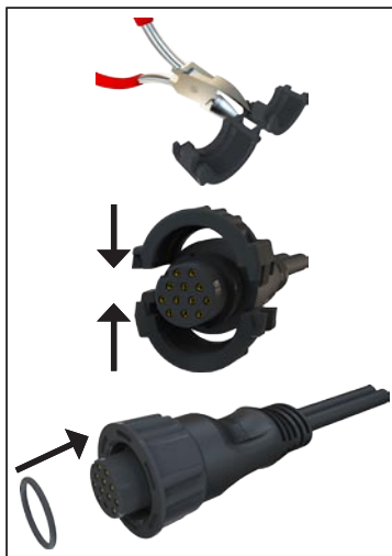
Instalación del anillo de fijación
