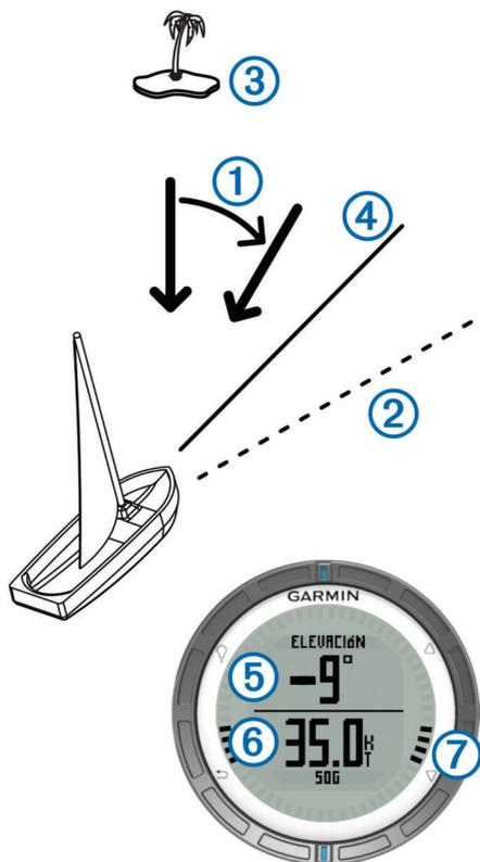
El dispositivo muestra la diferencia de grados entre el trayecto actual y el trayecto esperado ⑤, así como la velocidad sobre tierra ⑥. Las marcas del bisel ⑦ proporcionan una referencia rápida que representa el ángulo de elevación.
