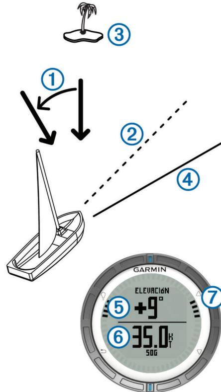
El dispositivo muestra la diferencia de grados entre el trayecto actual y el trayecto esperado ⑤, así como la velocidad sobre tierra ⑥. Las marcas del bisel ⑦ proporcionan una referencia rápida que representa el ángulo de elevación.
