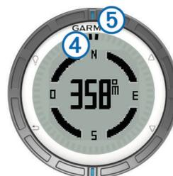
As duas marcas de ponteiro ④ servem como um ponteiro de rumo. A marca azul na parte superior ⑤ aponta a direção para a qual está virado.
