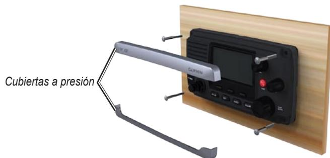
**NOTA:** los tornillos de acero inoxidable pueden atascarse cuando se fijan a una superficie de fibra de vidrio si se aprietan en exceso. Garmin recomienda la aplicación de un lubricante antiagarre que no permita la solidificación del acero inoxidable al tornillo antes de su utilización.
