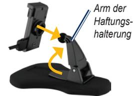
5. Lassen Sie die Halterung auf dem Arm der Haftungshalterung einrasten.
