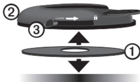
5. Posizionare il dischetto adesivo nella parte inferiore della base di montaggio ②.
