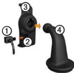
2. Encaja el soporte de sujeción sobre el brazo ④.
