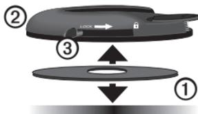
5. Coloca la almohadilla adhesiva en la parte inferior de la base de montaje ②.
