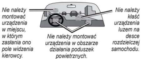
*Nie należy montować urządzenia w miejscu, w którym zasłania ono pole widzenia kierowcy.*
