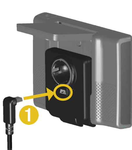
Koble til kabelen
