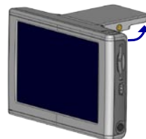
Antenne GPS sortie (parallèle au sol)
