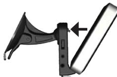
7. Stecken Sie das andere Ende des Zigarettenanzündersteckers in die Zigarettenanzünderbuchse im Fahrzeug. Das Gerät schaltet sich automatisch ein, wenn es angeschlossen und mit Strom versorgt wird.
