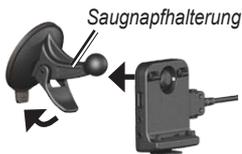
5. Setzen Sie die Unterseite des nüvi in die Halterung ein.
