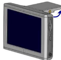
Antenne GPS sortie (parallèle au sol)
