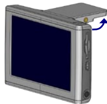
Antenna GPS sollevata (parallela al terreno)
