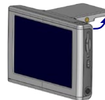
Antenne GPS sortie (parallèle au sol)
