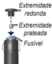
2. Retire o fusível (cilindro prateado e de vidro), e substitua-o pelo tipo de fusível adequado, que pode encontrar na parte lateral do transformador do veículo.
