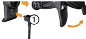
2. Schließen Sie das andere Ende des KFZ-Anschlusskabels an eine Stromquelle im Fahrzeug an.
