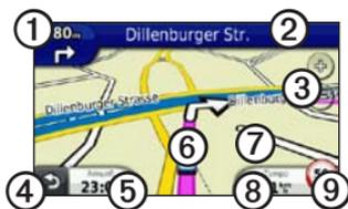
Die Route wird auf der Karte mit einer magentafarbenen Linie gekennzeichnet. Wenn Sie von der ursprünglichen Route abweichen, berechnet das Gerät die Route neu. Beim Fahren auf den meisten Straßen kann ein Symbol für Geschwindigkeitsbeschränkungen angezeigt werden.
