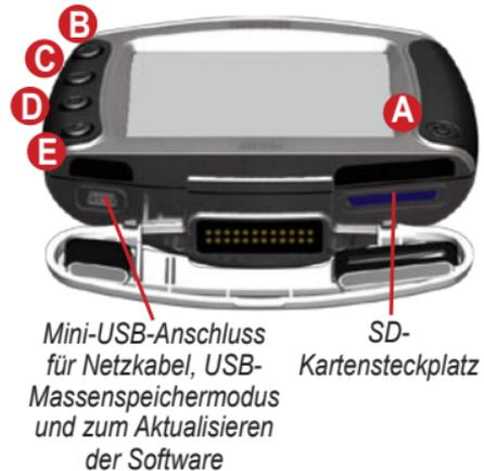
Mini-USB-Anschluss für Netzkabel, USB-Massenspeichermodus und zum Aktualisieren der Software
