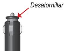
2. Retire el fusible (cilindro de color plateado y de cristal) y sustitúyalo por un fusible rápido de 3 A.
