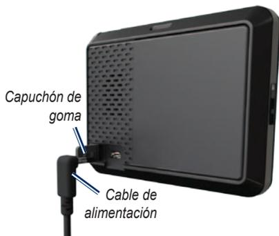
2. Enchufa el cable de alimentación del vehículo en el conector mini-USB.
