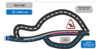
Kürzere Stauumfahrung: 3D Traffic Live
