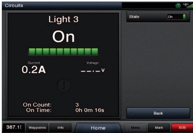
¿Te gustaría poder controlar con un solo toque el sistema eléctrico, el cargador de batería y los dispositivos virtuales desde tu plotter GPSMAP de la serie 8400 o 7400? Ni siquiera tendrías que estar cerca del muelle para arrancar el barco, poner en marcha las bombas o controlar las luces (incluidas las subacuáticas). De hecho, podrías tener acceso a los controles desde un mando a distancia o una aplicación de tu tableta.
