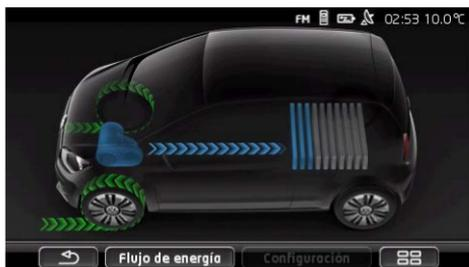
El vehículo circula y se frena, ya sea por acción de conductor o el freno motor.
